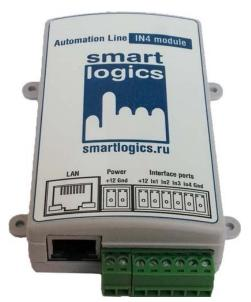
Модуль предназначен для организации управления путем подключения к нему внешних контактных интерфейсов: реле. кнопок, выключателей и т.п., и прием состояния входов через ЛВС.
